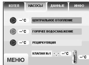
Насосы отображаются пиктограммой с температурой соответствующего контура возле изображения насоса. Работающий насос отображается зеленой пиктограммой, при остановленном насосе пиктограмма красная. Серая пиктограмма насоса обозначает, что насос не используется. Если датчик соответствующего контура не подключен, то вместо температуры отображается «---».
