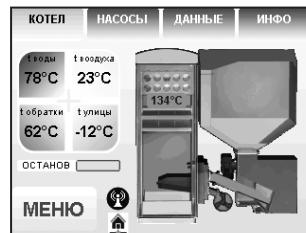
8.5.4. Появится экран, который предлагает запустить котел вручную. Необходимо нажать кнопку «ШНЕК» для заполнения горелки углем. После этого разожгите вручную топливо и кнопкой «ПОДДУВ» включите вентилятор. После того как горение угля станет устойчивым нажмите кнопку «АВТО» для перехода котла в автоматический режим.
