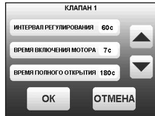
Пункт меню позволяет включить использование погодозависимого регулирования и настроить две точки графика регулирования температуры воды в контуре клапана. Настройка графика регулирования аналогична настройкам, описанным в п.п.8.7.8. Для работы погодного регулирования необходимо установить датчик температуры воздуха на улице. Погодное регулирование температуры воды в контуре клапана можно использовать совместно с погодным регулированием основного контура отопления.
