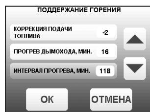
Выход из режима поддержания горения произойдет, когда расчетная мощность превысит заданную минимальную мощность. Например, при снижении температур теплоносителя и воздуха ниже установленных величин.
