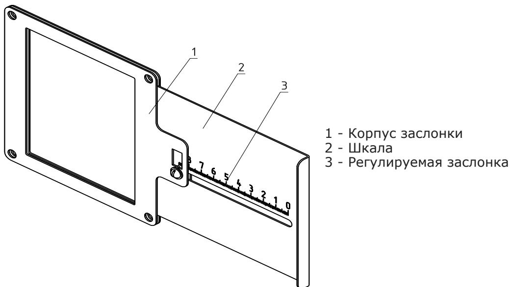
**Рис.12 Заслонка вентилятора**
