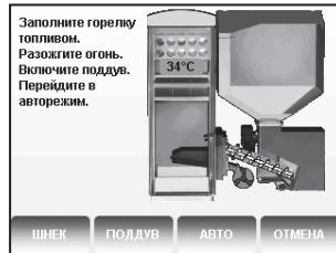
8.5.5. Если нажать кнопку «ПУСК/СТОП КОТЛА» когда котел уже находится в режиме горения, котел перейдет в режим «ОСТАНОВ» и горение топлива постепенно прекратится.
