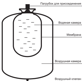
Рис.1 Конструкция бака
