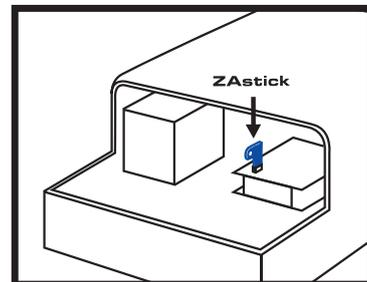
Преобразователь допускается открывать с целью установки или съема ZAstick только при отключенном сетевом проводе и по истечении не менее 5 минут ожидания (см. указания по безопасности)!
