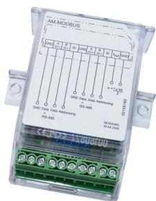
В случае необходимости, в предусмотренном для него гнезде может быть установлен дополнительный модуль (Монтаж
