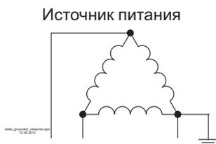
В системе трехфазного тока с заземленной сетевой фазой максимальное напряжение между внешним проводом и защитным проводом должно быть такой же величины, как и напряжение между двумя внешними проводами. В описанном здесь исполнении между местом подключения электропитания и защитным проводом «PE» допустимо максимальное указанное сетевое напряжение (см. технические характеристики), поэтому оно подходит для использования в заземленных системах треугольника!
