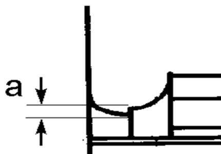
Следить за равномерным зазором "а" согласно рисунку. Напряжение за счет неровного прилегания может привести к задеванию крыльчатки и выходу вентилятора из строя.
