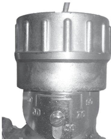
Рисунок 3. Положение гайки регулировочной при T теплоносителя 70°C.
