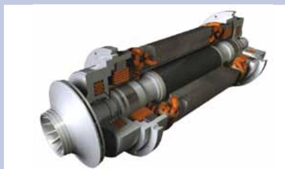
Чтобы исключить потери на механическое трение в приводном блоке, в холодильных машинах YMC2 используется технология активных магнитных подшипников и электродвигатели с постоянными магнитами.
