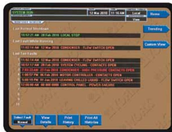
Панель регулирования OptiView обеспечивает полную диагностику и гарантирует быстрое устранение неисправностей.
