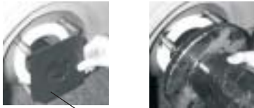
водораспределительная труба на обратной линии
