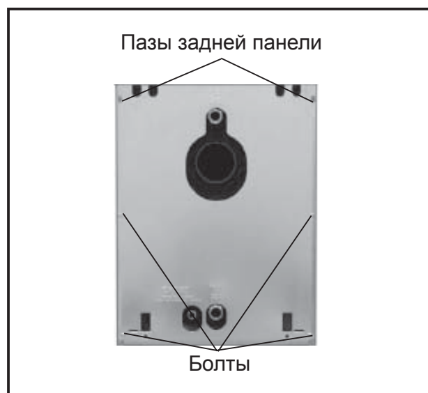
Рис.: Монтаж задней панели
