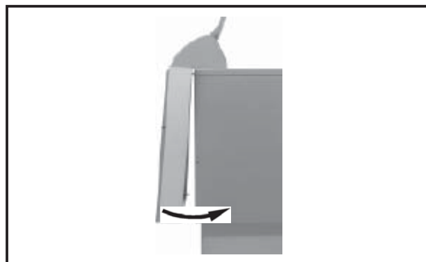
Рис.: Монтаж лицевой обшивки
