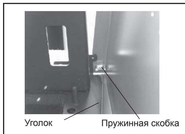
Рис.: Монтаж боковой обшивки
