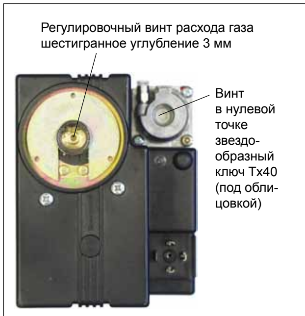
Рис.: Газовый комбинированный клапан
