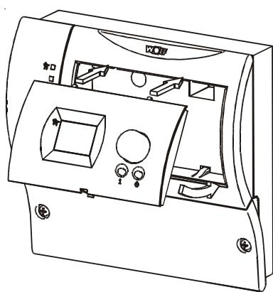
Модуль управления BM или модуль управления BM-Solar может быть установлен (зашелкнут) в модуль управления солнечными коллекторами. Кроме того, модуль управления BM может быть закреплен на настенном цоколе и использоваться в качестве устройства дистанционного управления.
