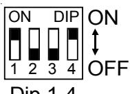
В корпусе модуля управления солнечными коллекторами расположены 4 DIP-переключателя (тумблера). Доступ к переключателям возможен после снятия крышки или удаления модуля управления.
