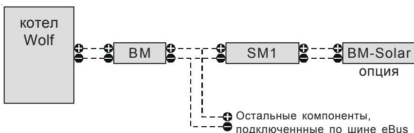
В этом случае управление модулем SM1 возможно как с контроллера BM с адресом 0, так и с контроллера BM-Solar.
