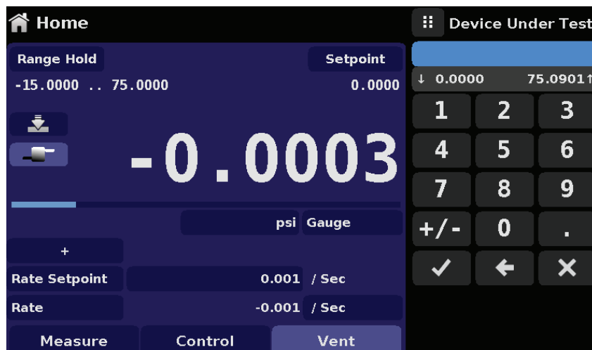
Рисунок 8.6.3-С - Давление DUT для выполнения процедуры продувки
