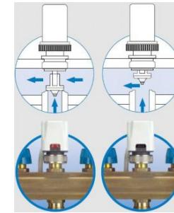
Если виден флагок индикатора сервопривод закрыт
