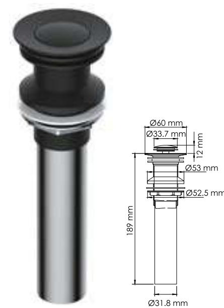
A250 Донный клапан Push-up для раковин без перелива. Покрытие черный Soft-touch.
