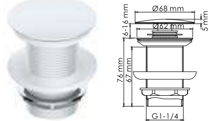
A246 Донный клапан Push-up для раковины без перелива покрытие белый Soft-touch.
