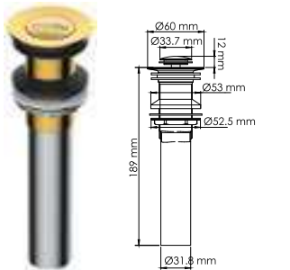
A253 Донный клапан Push-up для раковин с переливом PVD-покрытие «глянцевое золото».
