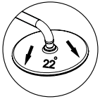
Душевая насадка Душевая насадка производится из нержавеющей стали. Форсунки из силикона с системой защиты от известковых отложений. Насадка крепится к штанге при помощи шарнирного соединителя, внутрь которого встроен сетчатый аэратор для равномерного распределения воды. Также шарнирный соединитель позволяет менять угол наклона душевой насадки от 0 до 22 градусов.
