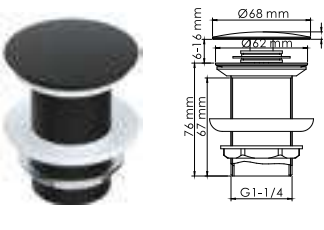
A245 Донный клапан Push-up для раковин с переливом Покрытие черный Soft-touch.
