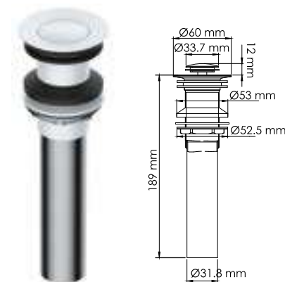
A251 Донный клапан Push-up для раковины без перелива покрытие белый Soft-touch.
