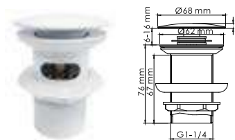
A153 Донный клапан Push-up для раковин с переливом Покрытие белый Soft-touch.
