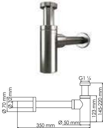
A172 Сифон для раковины PVD-покрытие «оружейная сталь».
