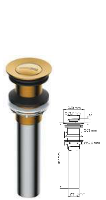
A252 Донный клапан Push-up для раковины без перелива. PVD-покрытие «матовое золото».
