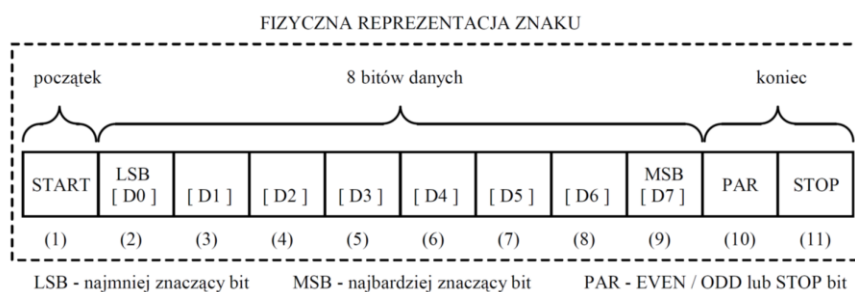
Рис. 8. Символьный формат в стандарте MODBUS RTU, используемый в преобразователе.
