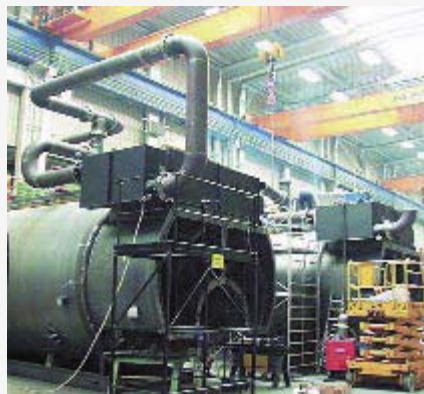
Процесс изготовления и готовый паровой котел серии Vitomax 200 HS с пароперегревателем
