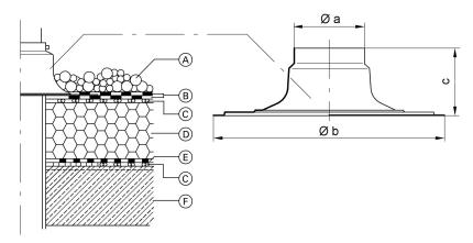
Конструкция крыши в соответствии со строительными правилами по сооружению плоских крыш
