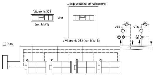
до 4 водогрейных котлов с Vitotronic 100 (тип GC1)
