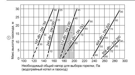
Измеренная от высоты патрубка отходящих газов на водогрейном котле до верхней кромки системы отвода отходящих газов.
