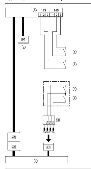
Контакты контроллера иерархически более высокого уровня с модуляционным регулятором:
