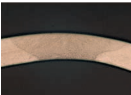
Обычный широкий шов, выполненный вольфрамовым электродом в инертном газе.
