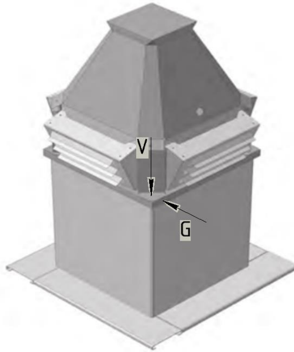
Рис. 7 Монтаж КРОС на стакане СТАМ
