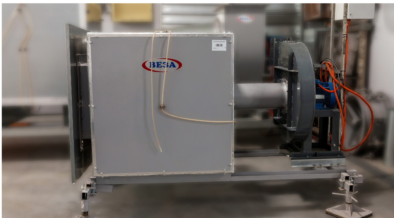
Стенд для определения предельного давления работоспособности клапана.
