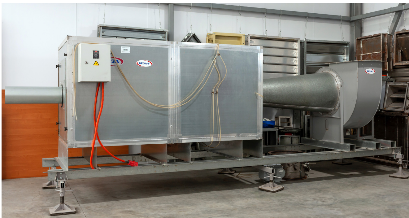
Стенд для определения аэродинамического сопротивления оборудования.
