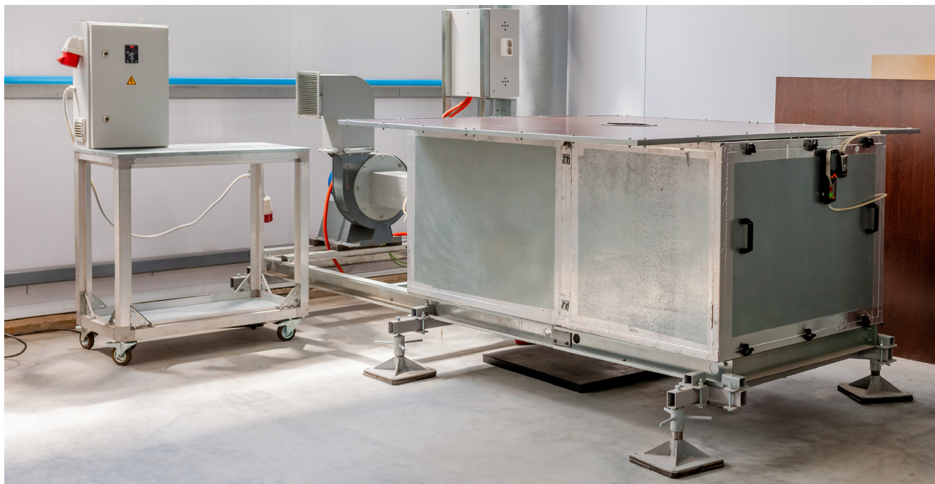
Стенд для определения объема протечек клапана.
