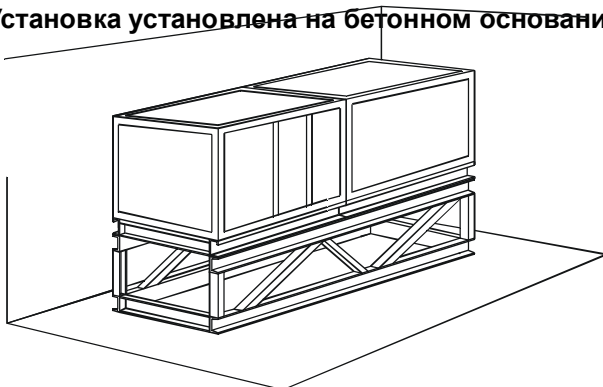
Установка установлена на дополнительной конструкции
