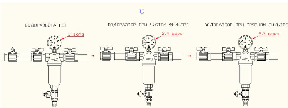
7.3. Промывка фильтра может производиться четырьмя различными способами:
