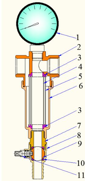
Фильтр состоит из корпуса 2 и колбы 6, выполненных из горячештампованной латуни CW617N с гальванопокрытием из никеля. Между собой корпус и колба соединены на резьбе с кольцевой прокладкой из EPDM.
