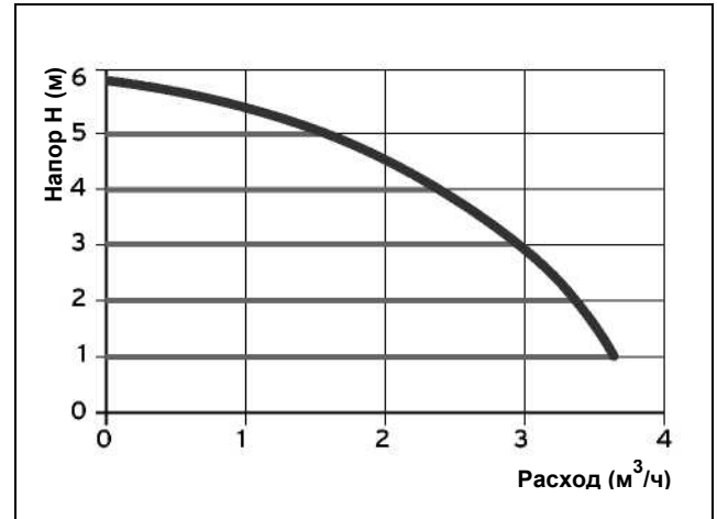
Рис . 1.3 Характеристика насоса с электронным регулированием ( \Delta p = постоянная величина)
