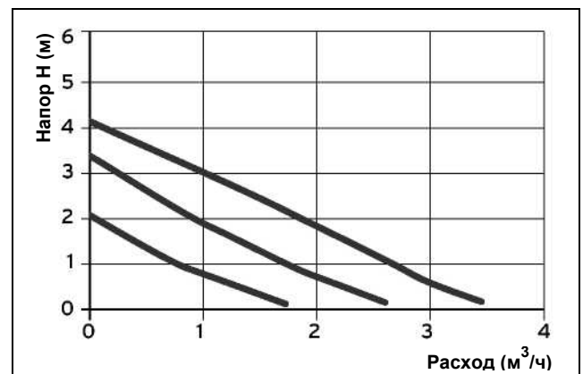
Рис. 1.7 Характеристика 3-ступенчатого насоса
