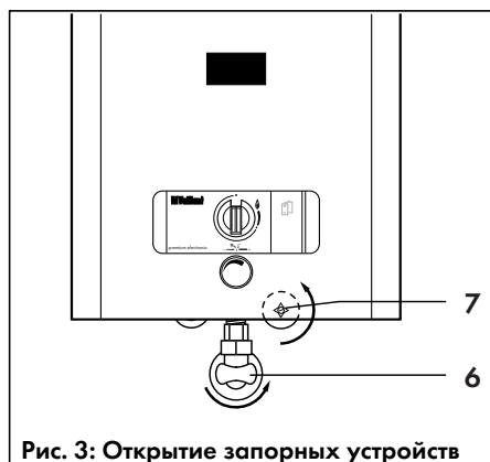
Рис. 3: Открытие запорных устройств
