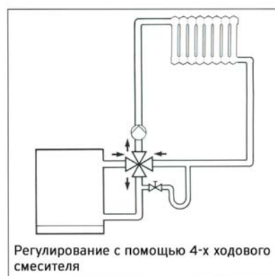
Устройство гидрозатвора в схеме со смесительным регулированием
