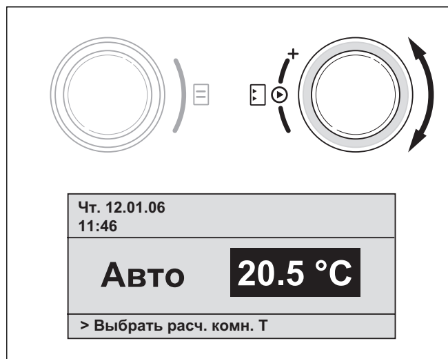
Рис. 4.10 Изменение заданной комнатной температуры в режиме основной индикации
