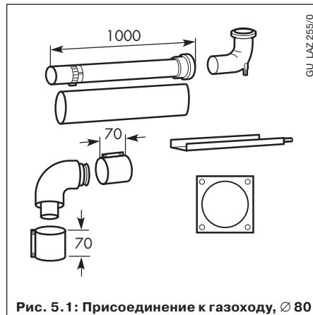
Рис. 5.1: Присоединение к газоходу, Ø80
