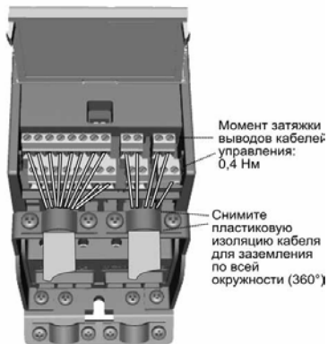
Рисунок 3.8: Смонтируйте кабели управления. См. главу 6.2
