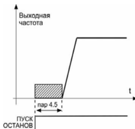
Рисунок 9.4: Время торможения постоянным током при пуске
