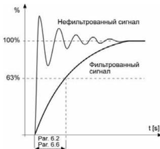
Рисунок 9.7: Фильтрация сигналов A11 и A12
