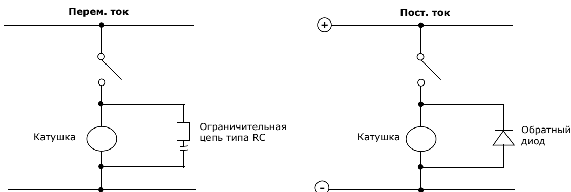
Рис. 4-10: Схема подключения для катушек реле и соленоидов переменного и постоянного тока
