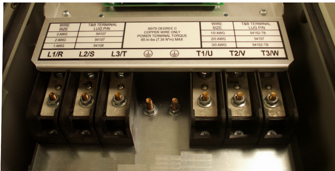
Рис. 4-2: Клеммы питания на моделях высокой мощности
