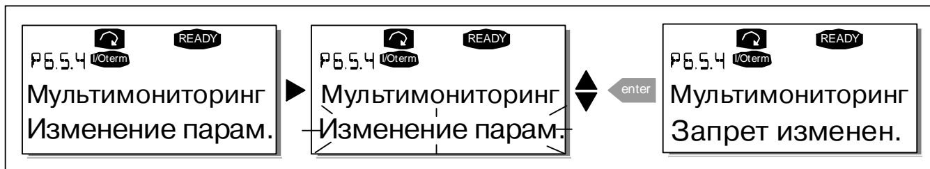
Рисунок 8-17. Разрешение на замену трех контролируемых параметров
