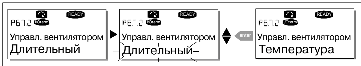
Рисунок 8-22. Функция управления вентилятором
