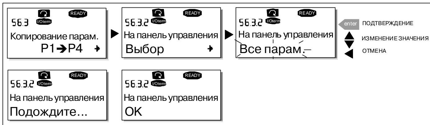
Рисунок 8-12. Копирование параметров в панель управления
