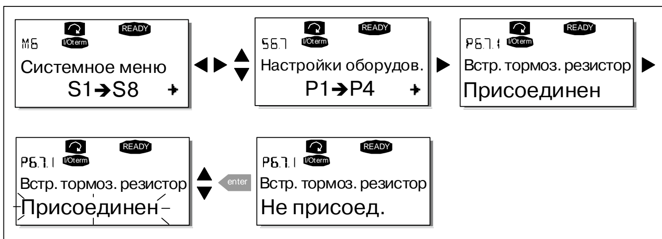
Рисунок 8-21. Подключение встроенного тормозного резистора
