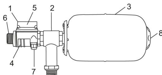
Комплект автоматики состоит из блока управления ТУРБИ – (1), пластикового тройника 1" с наружной резьбой для соединения с выходным отверстием насоса – (2) и гидроаккумулятора, емкостью 5 л – (3).
