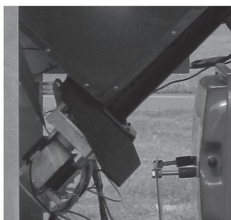
**Motoriduttore:** se il motoriduttore si ferma per la segnalazione **"ALAR-NO-ACC"** o **"ALAR-NO-FIAM"** la caldaia continua a funzionare fino a quando non si spegne la fiamma per mancanza di combustibile e fino a che non raggiunge il livello minimo di raffreddamento.
