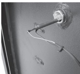
**Sonda di temperatura acqua:** se la temperatura dell'acqua si avvicina alla temperatura di blocco (100 °C) la sonda impone di interrompere l'alimentazione del pellet.
