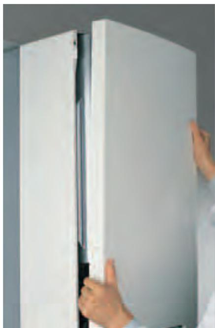
Демонтаж передней и боковой обшивки путем сдвига по вертикали
