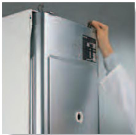
Открытие закрытой камеры сгорания при помощи специальной рукоятки
