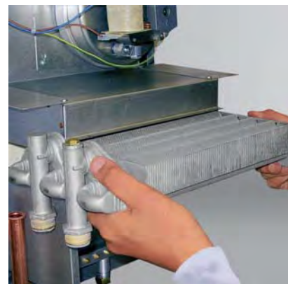
Снятие теплообменника выдвижением вперед
