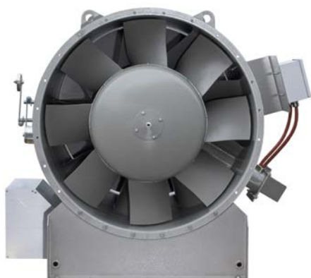
Рис. 20: Рабочее колесо BVAXN 8/56, смонтировано С 8 лопатками, приваренных к ступице под расчетным углом в соответствии с заданной производительностью. Лопатки рабочего колеса не регулируются.
