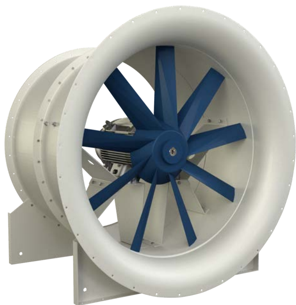
Рис. 19: Рабочее колесо AXO 9/27, смонтировано С 3 - 9 лопатками, которые приварены к ступице под расчетным углом ножа в соответствии с желаемой производительностью. Лопатки рабочего колеса не регулируются.
