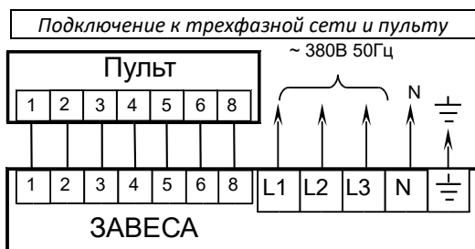
Рис. 3. Схемы подключения завес к электросети и пульту управления
