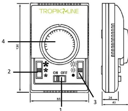
1 – переключатель **ON/OFF** для включения/выключения тепловентилятора
