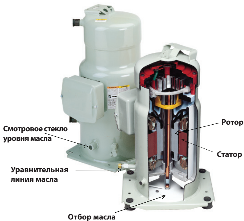
Рисунок 1. Спиральный компрессор
