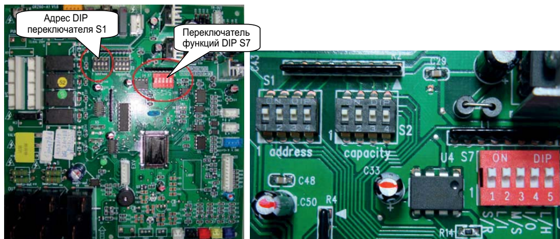
Главная плата управления, переключатель функций DIP - 5 тумблеров.
