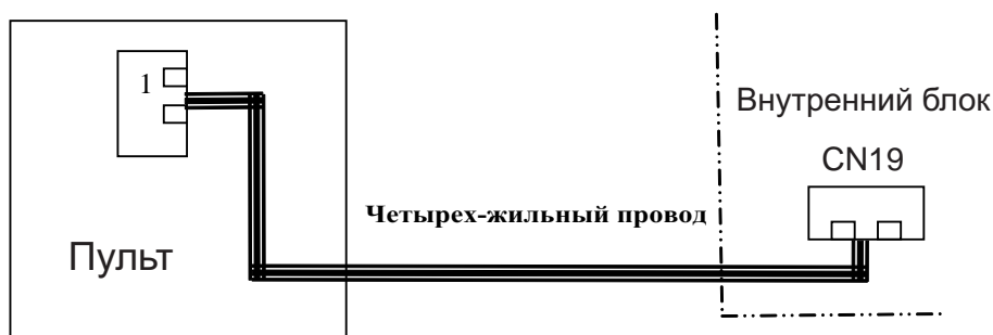
Рис. Б. Подключение линии связи с проводным пультом управления.
