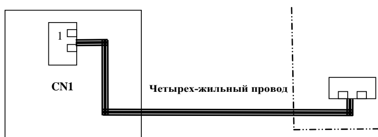
Рис. Б. Подключение провода питания и линии связи с проводным пультом управления.
