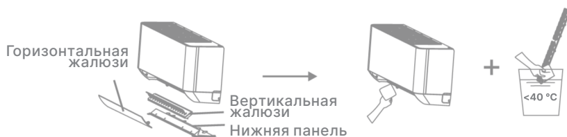
Рисунок 12 — Очистка внутренних полостей внутреннего блока
