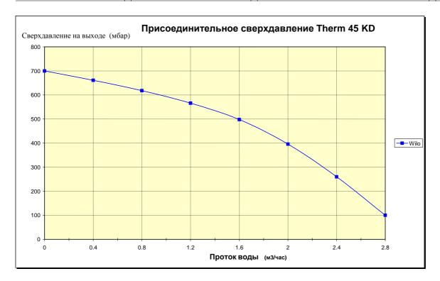
**Предупреждение**: Кривая применимых присоединительных сверхдавлений воды отопления расчитаны на насосы Wilo 15/7-3 на максимальную степень регуляции. Не рекомендуем снижать мощность насоса.
