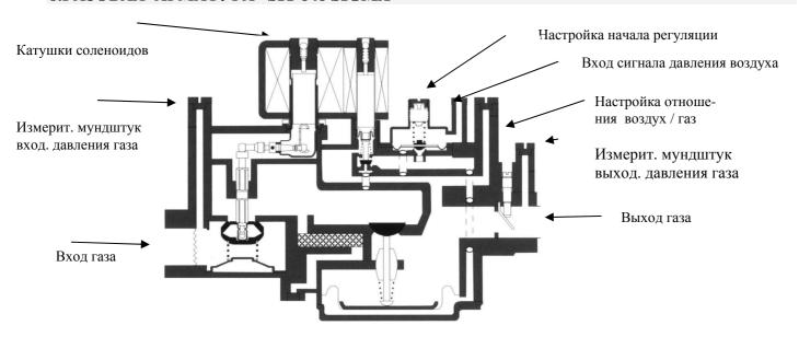
SIT 848 SIGMA — это газовая арматура с регуляцией отношения воздух / газ. Оснащена двумя соленоидными клапанами блокировки просачивания газа в состоянии бездействия котла. Система регуляции работает в зависимости от сигнала обратной связи давления газа из смесителя. Кроме закрываемых измерительных наконечников измерения входного, выходного и среднего давлений газа арматура имеет элементы настройки правильного отношения воздух/газ в полном диапазоне регуляции мощности котла.
