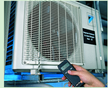
Измерения в недоступных местах с testo 465
