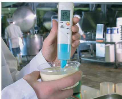
testo 206-pH2 идеален для измерения в полутвердых веществах
