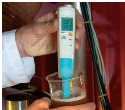
testo 206-pH1 идеален для измерений в жидкостях
