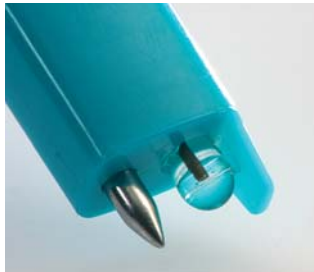
pH1 наконечник зонда для жидкостей
