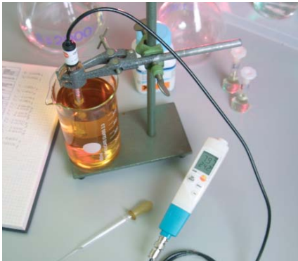
testo 206-pH3 обеспечивает подключение внешних зондов
