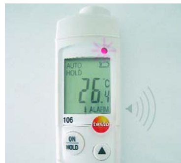
Акустический и оптический сигнал тревоги (LED мигает)
