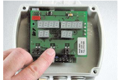
Кнопки hygrotest 500D и 600 находятся внутри корпуса.
