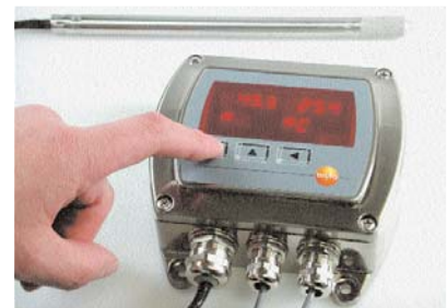
Кнопки управления hygrotest 650 находятся на корпусе.
