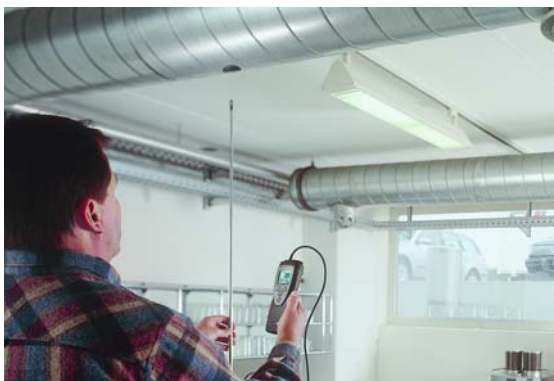
testo 425, используется, например, для настройки кухонных приточных вентиляционных каналов
