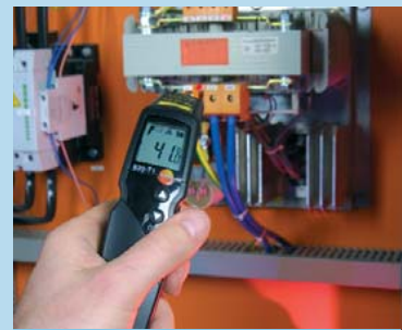
Измерительная точка диаметром 2 мм (testo 830-T3)
