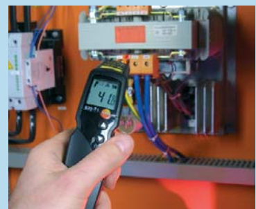
Измерительная точка диаметром 2 мм (testo 830-T3)
