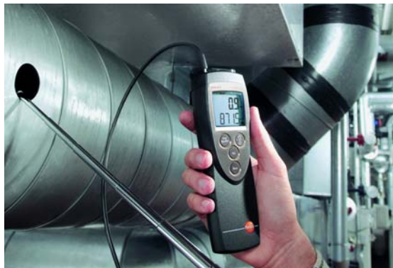
testo 425 используется, например, для мониторинга объемного расхода в системах вытяжной вентиляции
