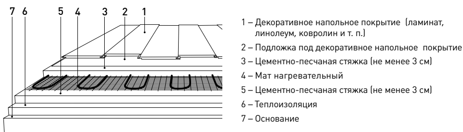
Схема укладки под ламинат, линолеум или ковровин в холодных помещениях
