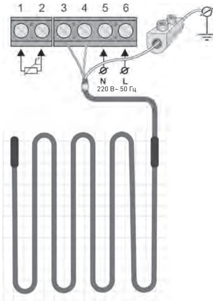
Рис. 4. Схема подключения
